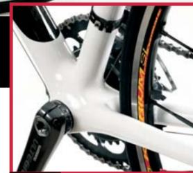
**6** Nel **movimento centrale** si ripropone la situazione già descritta riguardo il **nodo di sterzo**, ovvero un sovradimensionamento dei raccordi dei vari segmenti che partono dalla scatola del movimento centrale.
