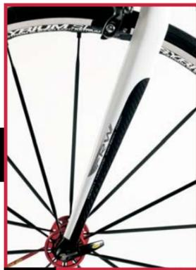
**4** La forcella montata sulla **Hunters Hill** ruota su di una serie sterzo **Ritchey Pro** del tipo a scomparsa totale. Per l'importante **componente** dello sterzo, **Freewheeling** ha scelto un prodotto ben collaudato e apprezzato della giapponese **Mizuno**, la MC52 monoscocca.
