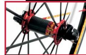
**5** I mozzi delle **ruote Mavic Ksyrium SL** giocano sul **contrasto cromatico** tra il corpo centrale in fibra di carbonio e le flange **anodizzate in rosso**. Su queste ultime convergono i raggi in **Zical** generosamente dimensionati.
