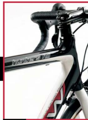
**3** Nella zona del tubo di sterzo, la **raccordatura** delle singole tratte del telaio è molto ampia - così come suggerisce il manuale della perfetta costruzione **monoscocca** - per ampliare i bracci resistenti delle sezioni interessate. Il tutto è stato poi alleggerito dalla **grafica**.
