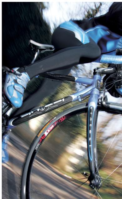
**1** La forcella che completa questo telaio è sempre di produzione Sintesi: consta di una struttura interamente in fibra di carbonio e adotta un sistema di curvatura molto regolare e affatto pronunciato. La sezione è maggiorata in prossimità della testa forcella e rastremata verso i forcellini in alluminio.
