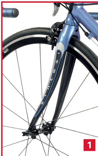
**2** Le ruote, della Xero modello Xr1, hanno il cerchio a medio profilo, con pista frenante rettificata e sono gommate con il modello Xenith della Maxxis.
