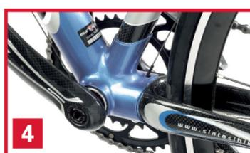
**1** Per ciò che concerne il carro posteriore, da notare in particolar modo, oltre che le sezioni degli elementi, soprattutto le connessioni estremamente solide con il nodo di sella e con la scatola del movimento centrale.
